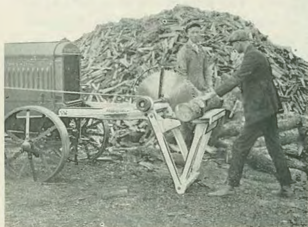
Ilustración No. 8—Tractor de la International Harvester Company y aserradora de leña "Forest King" trabajando para aserrar la provision de leña para el invierno.
